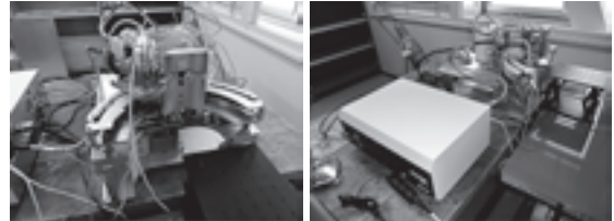
図1 ポータブルX線回折・蛍光X線分析装置
